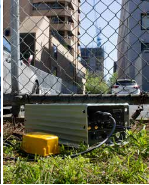
Vibration Monitoring Terminal (meten van grond trillingen).
