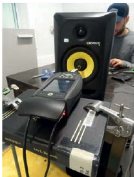
FIGUUR 3: METING VAN HET LAAGFREQUENT GEDRAG VAN EEN LUIDSPREKER MET BK 2270 EN ARTA WAARBIJ HET BOEK VAN BERANEK CREATIEF GEBRUIKT WORDT.
