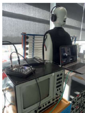
FIGUUR 2: METING FREQUENTIEKARAKTERISTIEK MET BK HATS EN DE BK 2131 FREQUENCY ANALYSER
